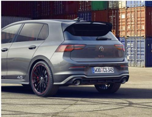
Mit «Race Paket»: speziell durchströmter, offener Dachkantenspoiler für höheren Abtrieb, 19-Zoll-Spezialfelgen und eine Akrapovič-Sportabgasanlage.
