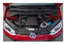
Il motore 1.0 TSI da 115 CV della up! GTI
